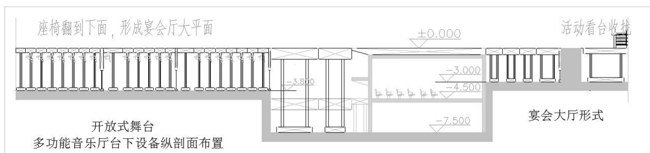
图 A.7.3 多功能音乐厅台下设备纵剖面布置（宴会厅形式）
